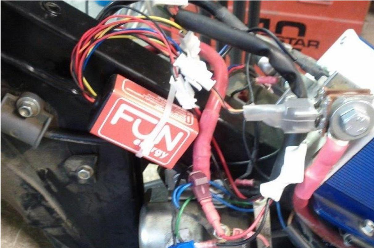
Mit einem Kabelbinder wird der Powercontroller am Rahmen befestigt.
