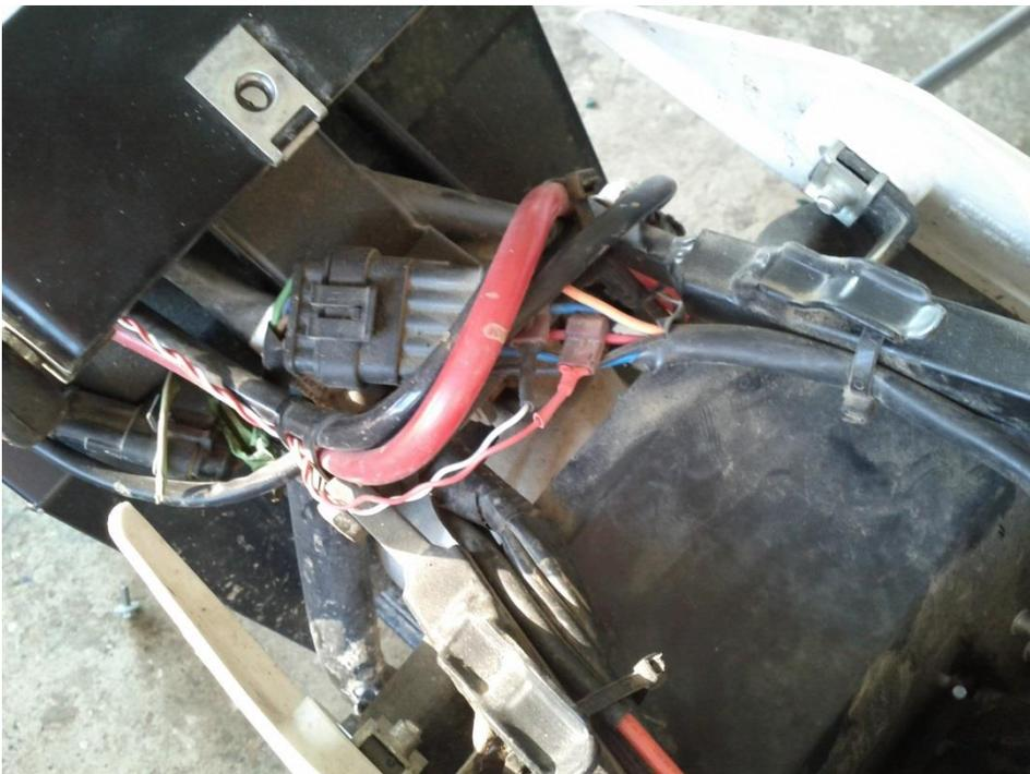
Hier werden die Abzweigverbinder mit einer Flachzange auf die oben markierten Leitungen gequetscht und dann die Versorgungsleitung angesteckt.
